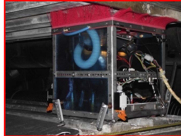
Lock Super Cleaner เข้ากับร่องของ SCAF Dryer
