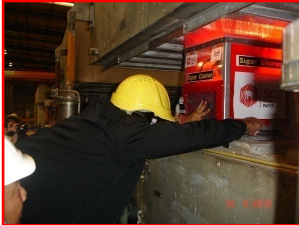
นำ Super Cleaner เข้าไปใน SCAF Dryer
