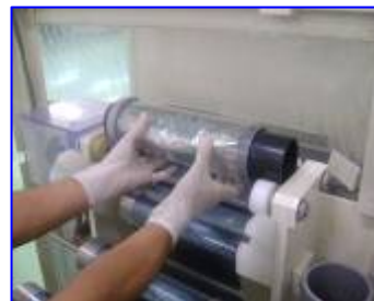
นำแผ่นพลาสติกที่ลอกออกเข้าม้วน แบบที่ 2
