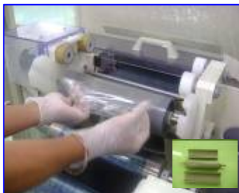
นำแผ่นพลาสติกที่ ลอกออกเข้าม้วนแบบที่ 1
